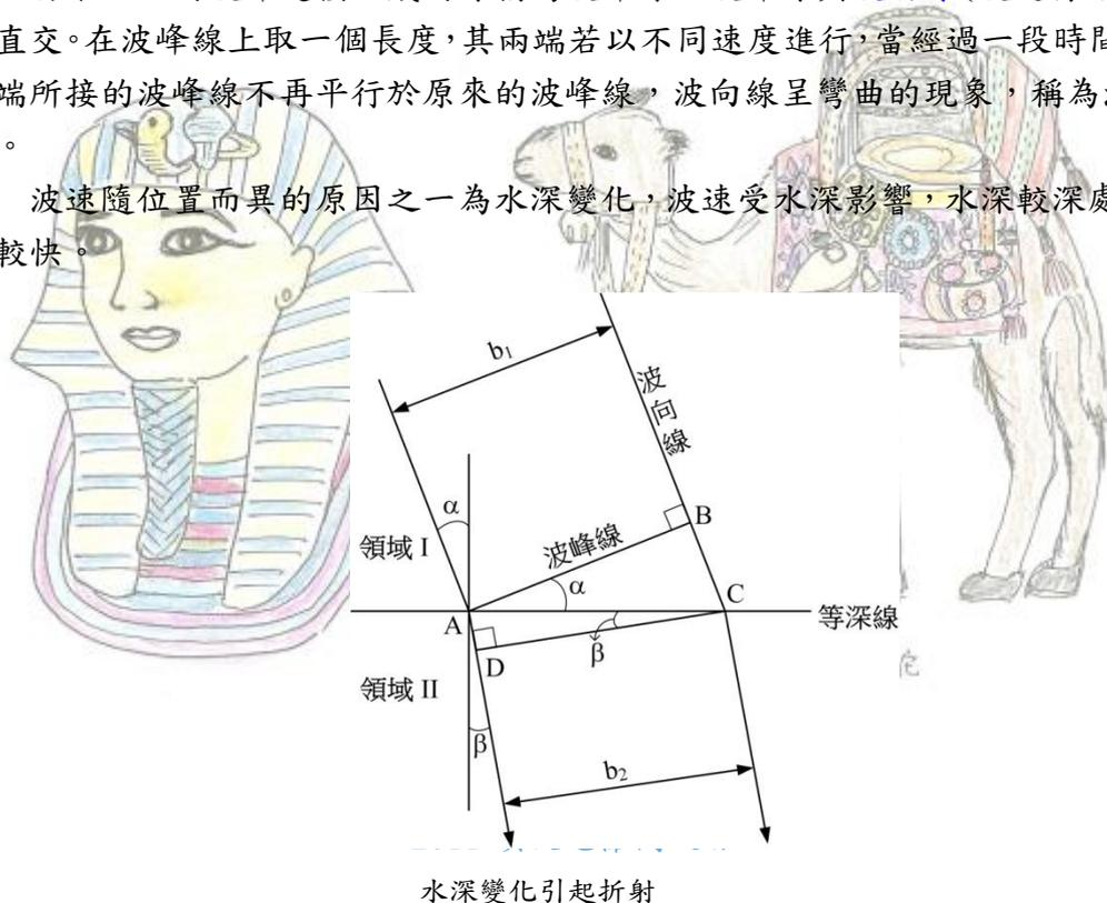
如圖所示 AC 為等深線，將水域分成水深較深的領域 I 及較淺的領域 II。左側的波向線與等深線交於 A 點，通過此點的波峰線上距離為  $b_1$  處定為 B 點。在 B 點處係以領域 I 的波速  $C_1$  進行，達等深線所需時間為距離 BC 除波速  $C_1$ ，這時間內，原來在 A 點的波會以  $C_2$  的波速進行至 D 點而得下列關係。
